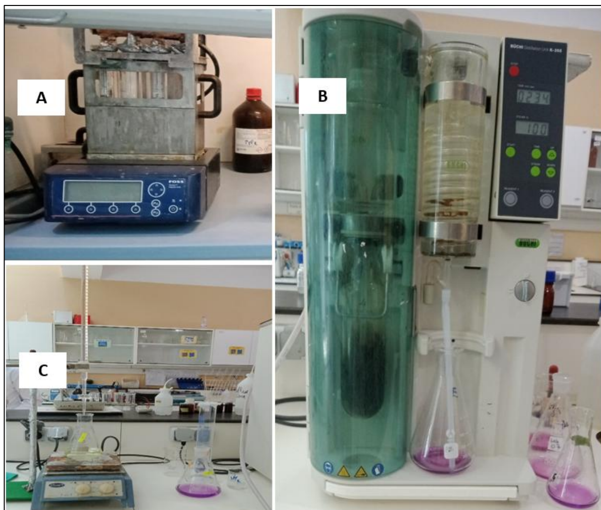
Figure. 12 : Appareil Kjeldahl : A : Unité de minéralisation ; B : Unité de distillation C : Titration.
