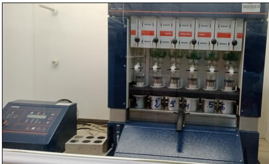
Figure. 13 : Extraction de la matière grasse à l'aide d'un appareil à système Soxhlet semi-automatique.
